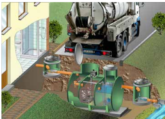
Netipska MKČN – odvajanje odpadne vode preko pretočne greznice v rastlinsko ČN
