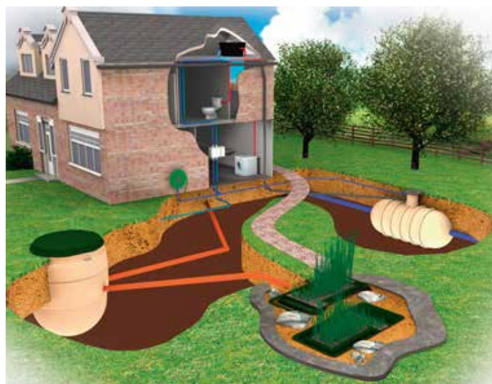
Pravilna vgradnja tipske MKČN
